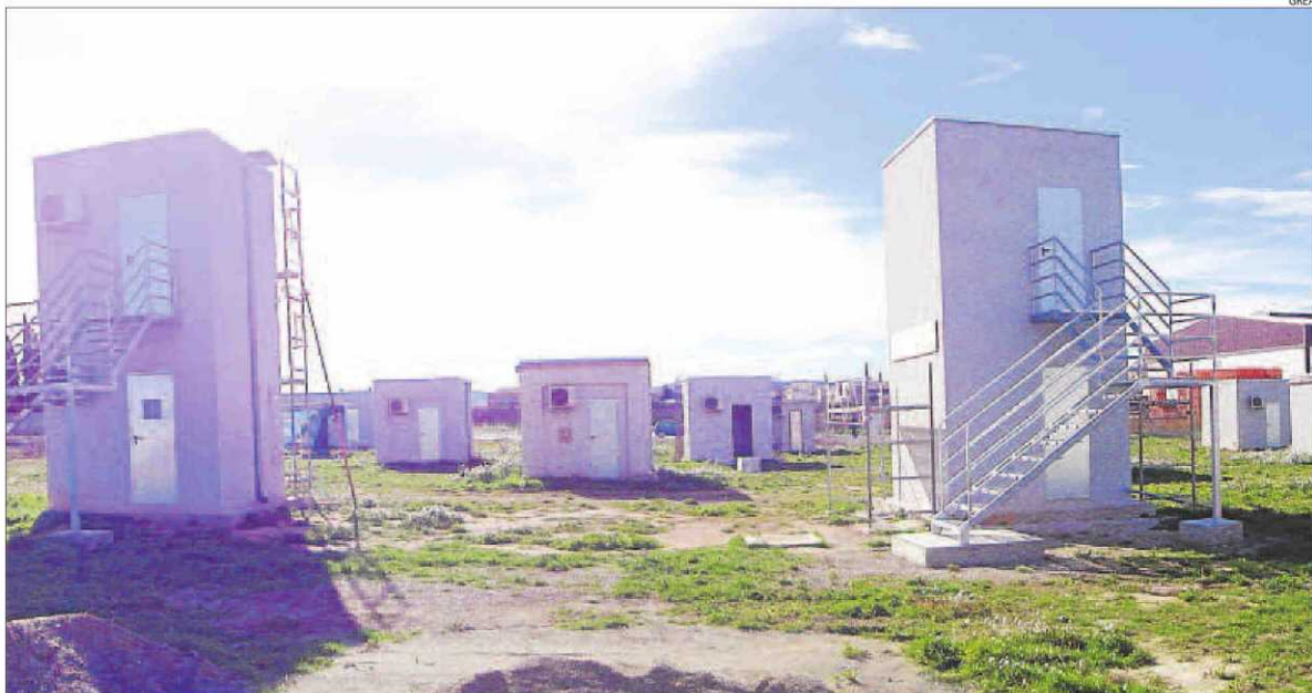
Aquests edificis experimentals situats a Puigverd han servit per dur a terme els experiments sobre emmagatzemament d'energia tèrmica.
