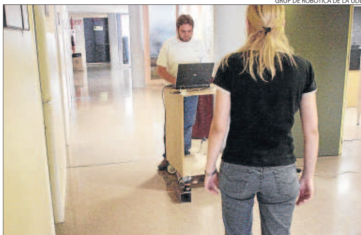
El sensor, al terra, detecta la forma de caminar de les persones.
